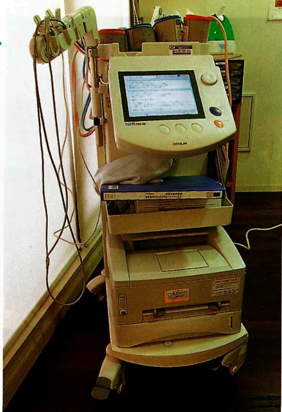
血圧脈波検査 (ABI/PWV検査)。動脈硬化を調べる検査には、動脈の硬さを調べるPWV検査と、血管の詰まり具合を調べるABI検査がある
